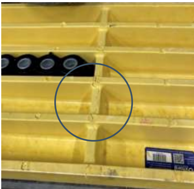
Riss entlang einer Querverstrebung
